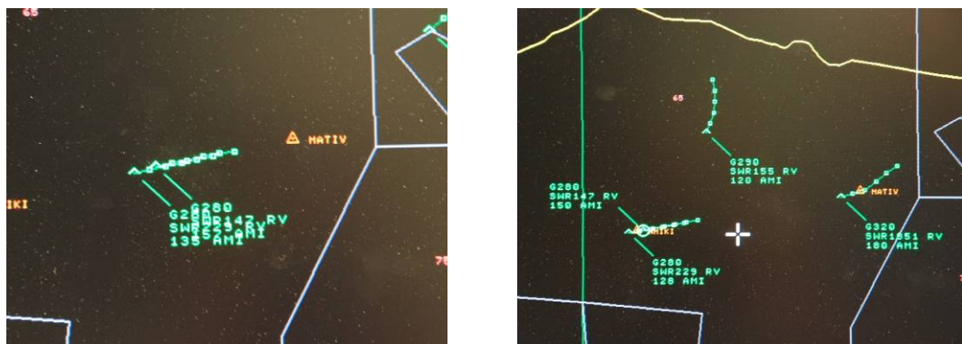
Abbildung 1: Links: Überlagerte Radaretiketten von SWR 229 und SWR 147, wie sie dem Flugverkehrsleiter in der Standardeinstellung des radar display dargestellt wurden. Da die Radaraufzeichnung ( legal recording ) die Einstellungen des radar display nicht wiedergibt, ist die tatsächliche Darstellung nicht rekonstruierbar. Rechts: Darstellung von SWR 229 und SWR 155 mit nicht überlagerten Radaretiketten. Diese Darstellung kann vom Flugverkehrsleiter per Mausclick gewählt werden.
