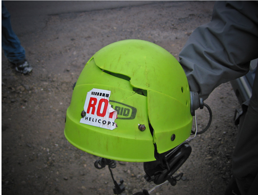
Bild 9: Beschädigter Helm des verunfallten Forstwartes
