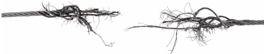
Fig. 7: Etat du câble gauche de la commande du gouvernail de direction, après sa rupture.
