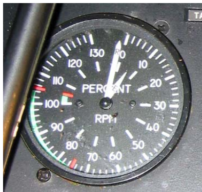
Figure 7: La grande aiguille avec l'indication „R” montre le nombre de tours du rotor et celle avec l'indication „E” le nombre de tours de la turbine. L'indication est en pourcentage du nombre de tours nominal.
