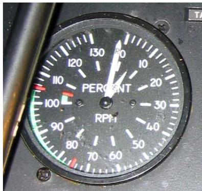
Bild 7: Der grosse Zeiger mit der Bezeichnung „R“ zeigt die Rotordrehzahl und derjenige mit der Bezeichnung „E“ die Turbinenausgangsdrehzahl. Die Darstellung ist in Prozent der Nominaldrehzahlen.
