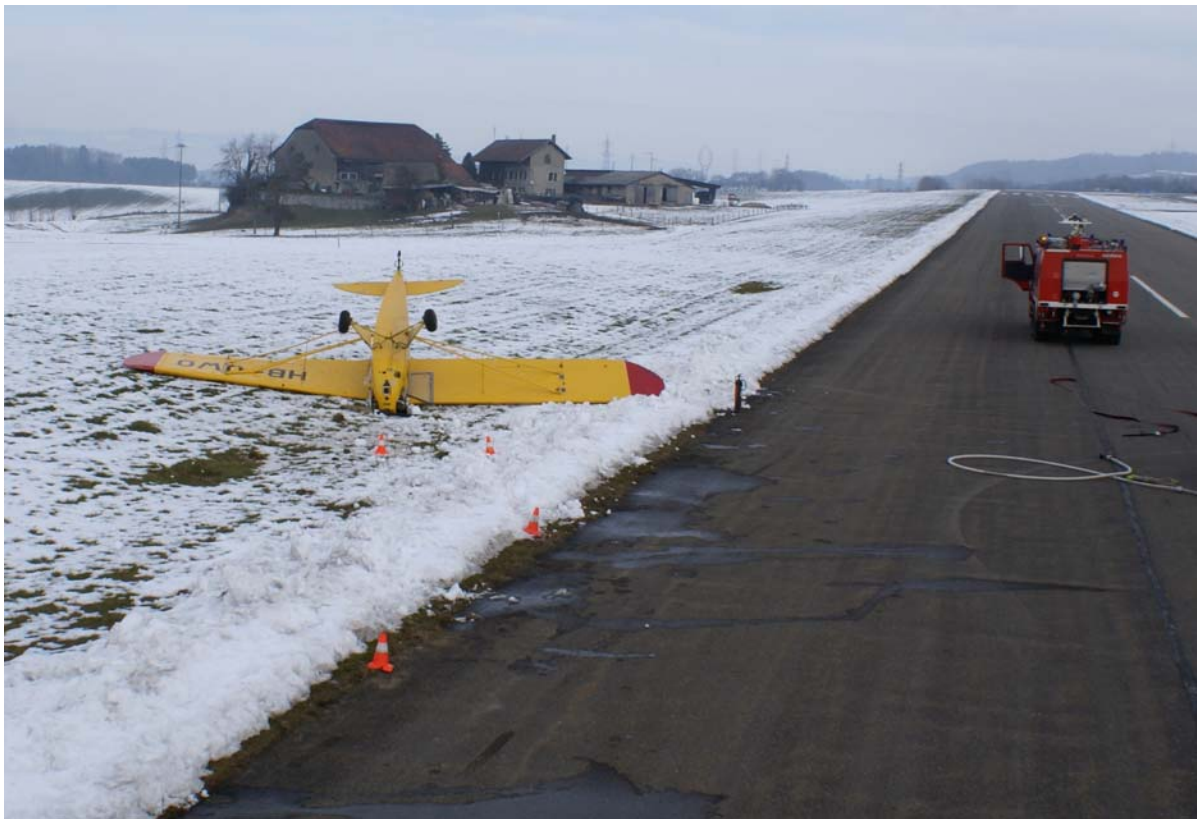
Photo 1: position finale de l'avion HB-OWO, bordure de neige et état de la piste
