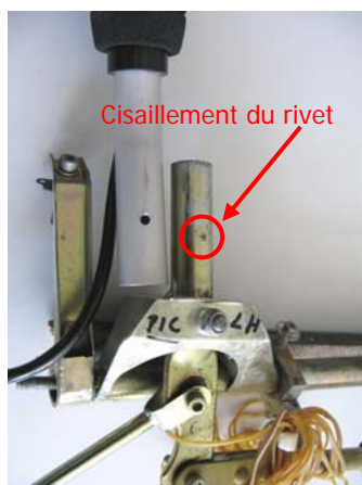
Fig. 4 et 5 Manchette côté gauche, détails du cisaillement du rivet de type POP en aluminium de 3.2 x 6
