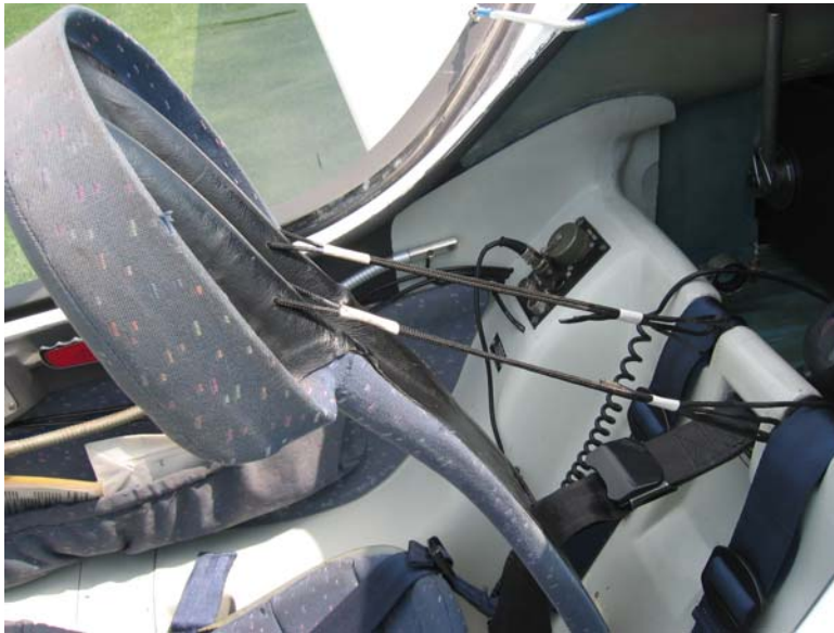
Illustration 3: Cordelettes de fixation sur un DG-505 MB
