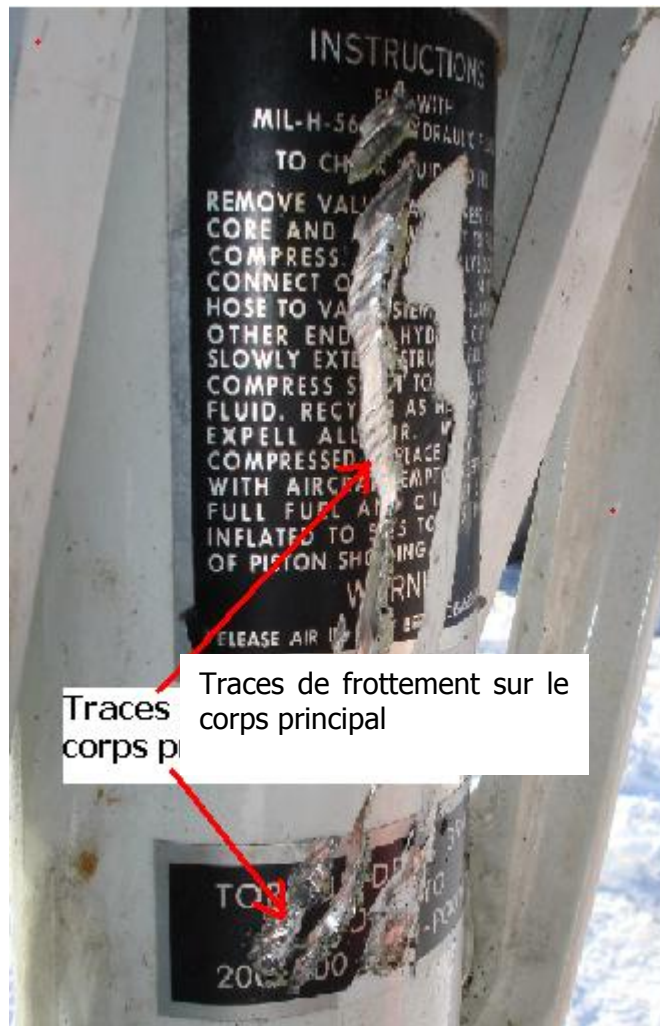
Fig. 6: Traces de frottement sur le corps principal du train d'atterrissage
