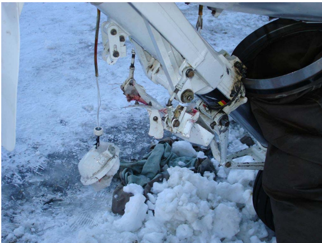
Fig. 3: Bugfahrwerk während des Auftauens
