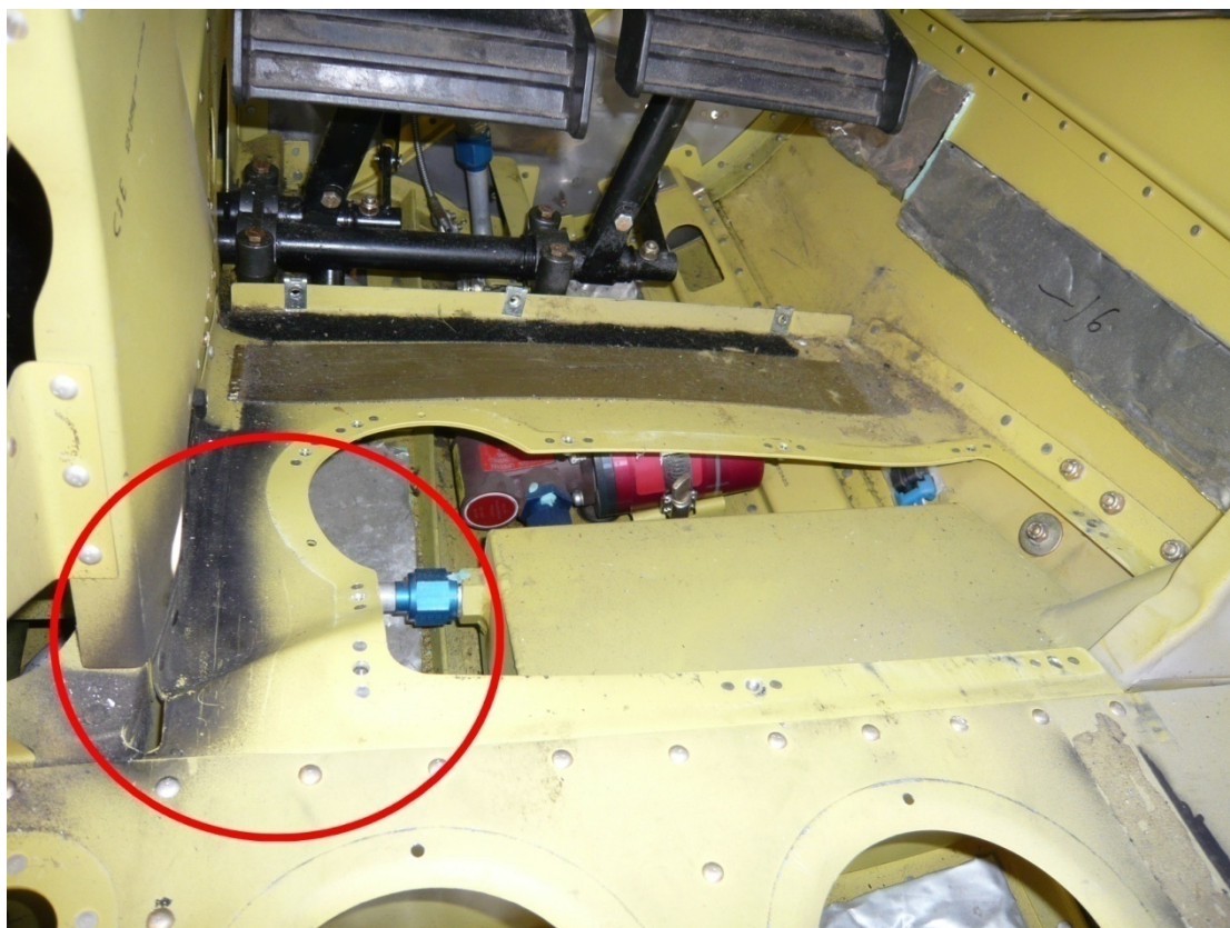
Fig. 6: HB-CQR Déformation du plancher de la place avant droite.
