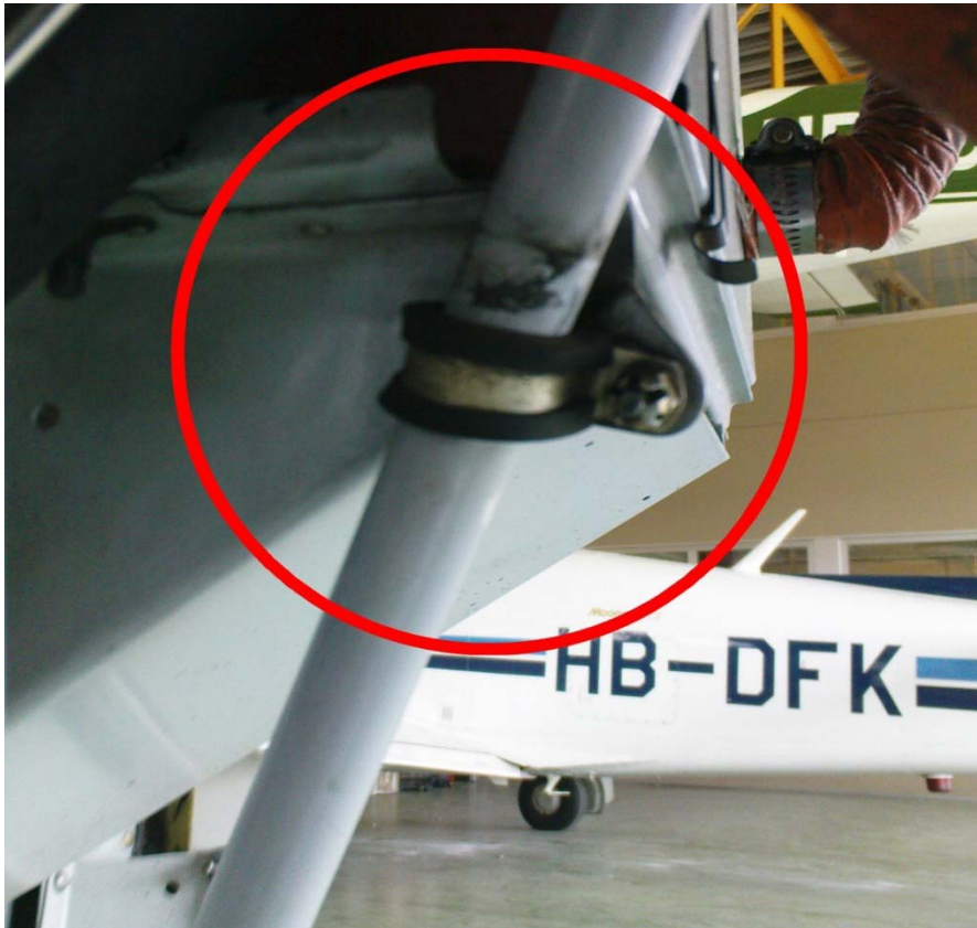
Fig. 3: HB-CQR Déformation du support de batterie et trace de déplacement lors du choc.
