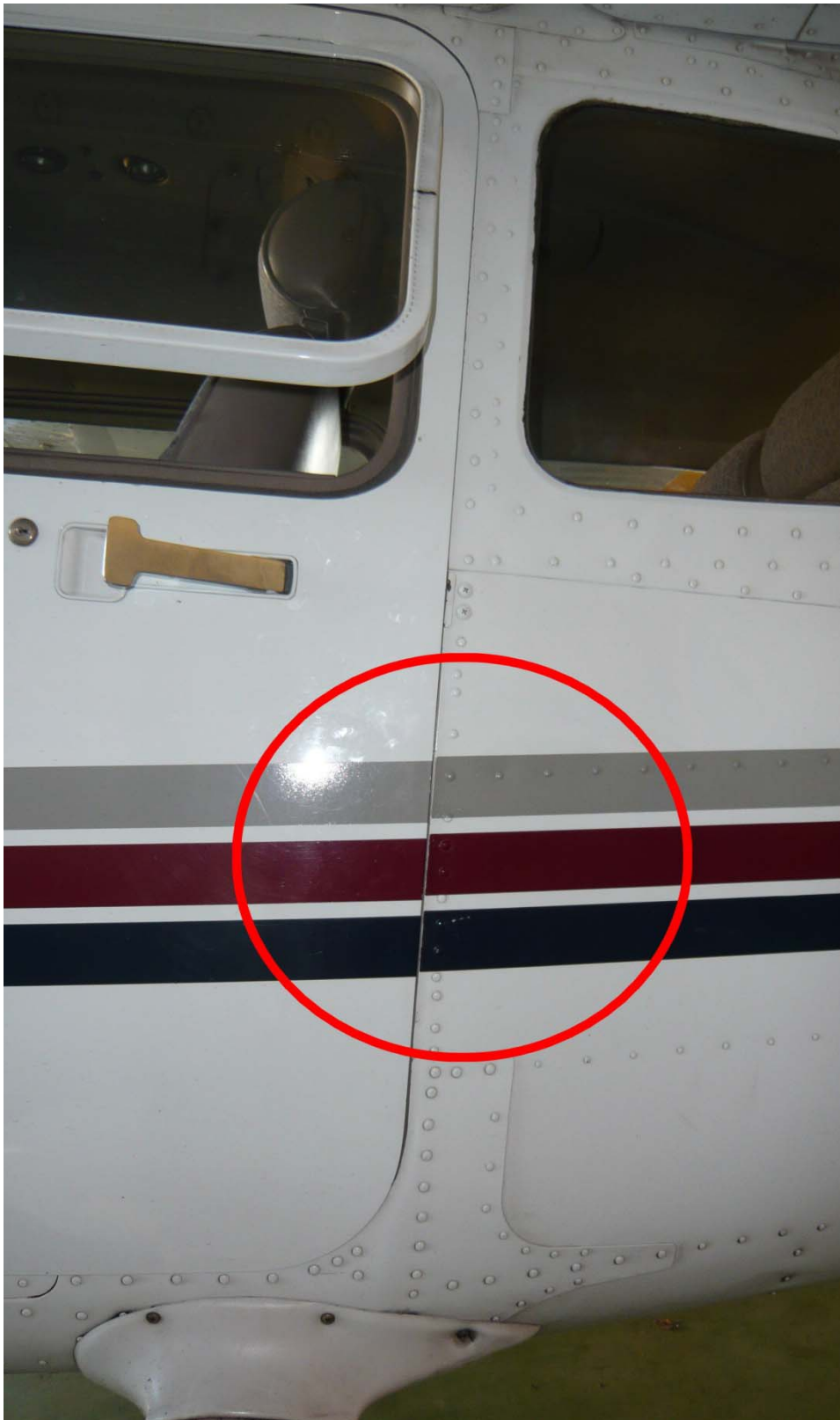
Fig. 4: HB-CQR Déformation du cadre de la porte gauche. Les marques de peinture ne sont plus alignées.
