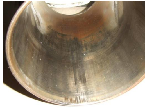
Fig. 6: Traces de frottement dans le cyl. n° 2
