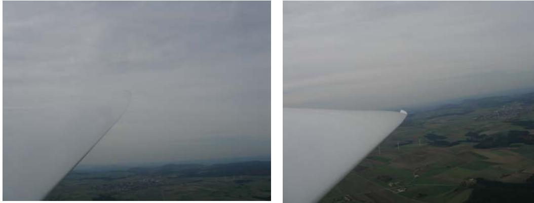
Abbildung 3: Bilder des Herstellers aus einem Ventus bT (vergleichbares Baumuster) links: WK -1 Geschwindigkeit ca. 160 km/h; rechts: WK +2 Geschwindigkeit ca. 190 km/h
