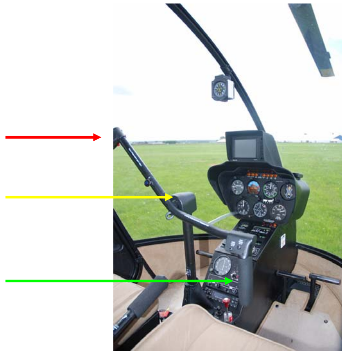
Abbildung 2: Anordnung der Doppelsteuerung vor dem Unfall
