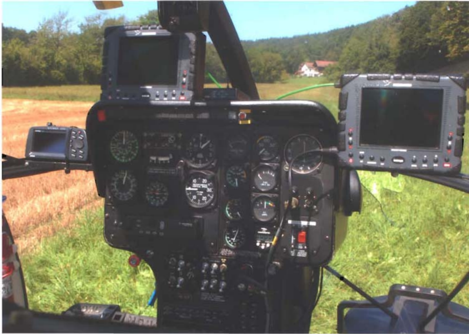
Abbildung 7: Sicht aus Cockpit, Pilotenseite links Garmin GPS, je ein Kameramonitor für Pilot und Regisseur.
