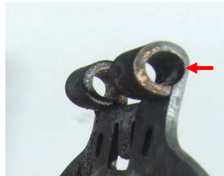
Fig. 2: Traces d'usure sur la charnière du flotteur
