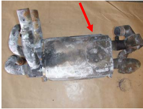
Fig. 3: Muffler -Gehäuse mit Loch
