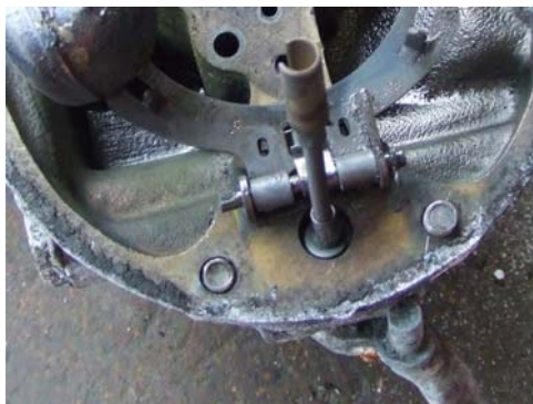
Fig. 1: Schwimmerscharnier und Nivelliergefäss Fig. 2: Abnützungen am Schwimmerscharnier
