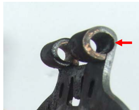
Fig. 1: Schwimmerscharnier und Nivelliergefäss Fig. 2: Abnützungen am Schwimmerscharnier
