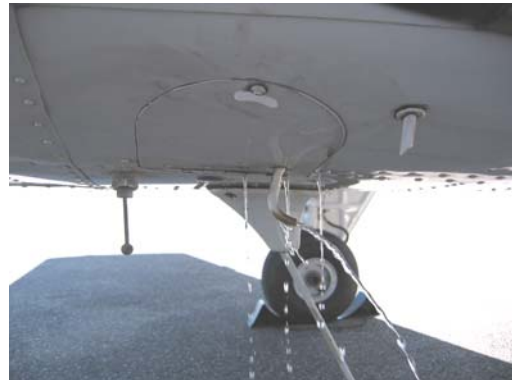
Fig 3: Fuite de carburant à travers la purge principale avec moteur à l'arrêt
