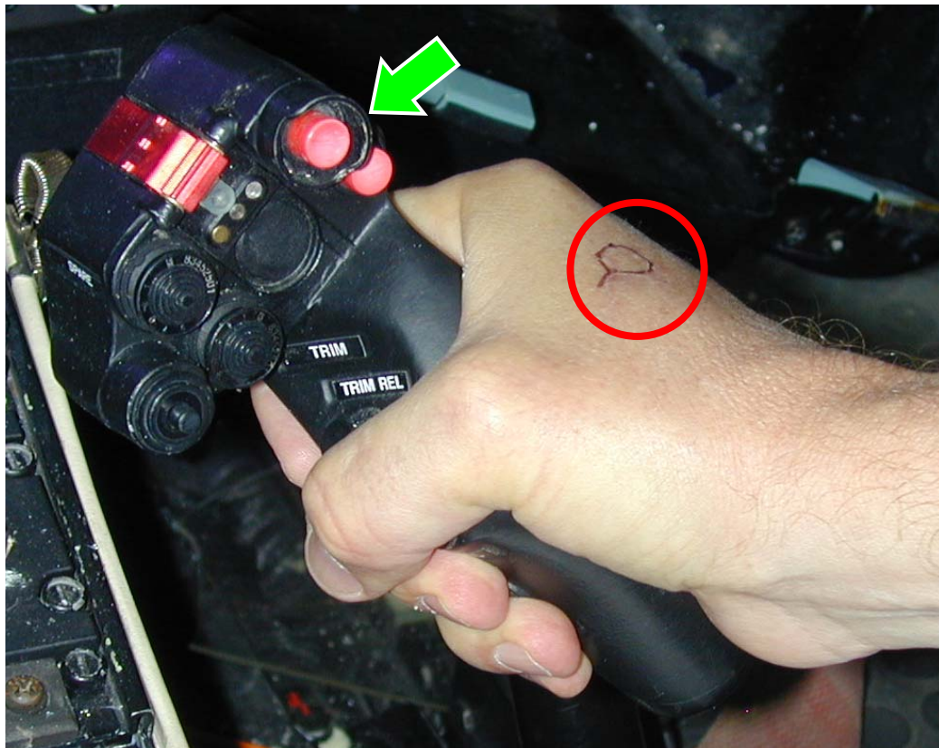
Photo 9: Main du pilote lorsque le manche à balai ( cyclic stick ) est tenu. Le cercle rouge désigne la blessure qui a été surlignée en noir afin d'être plus visible. La flèche verte est pointée sur la bordure protégeant l'interrupteur de largage de la charge extérieure, très vraisemblablement à l'origine de la blessure.
