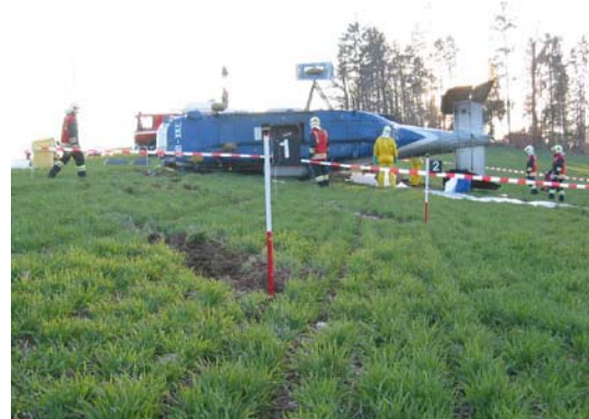
Fig. 5: Erste Kontaktsuren des hinteren Fahrwerkes mit dem Gelände
