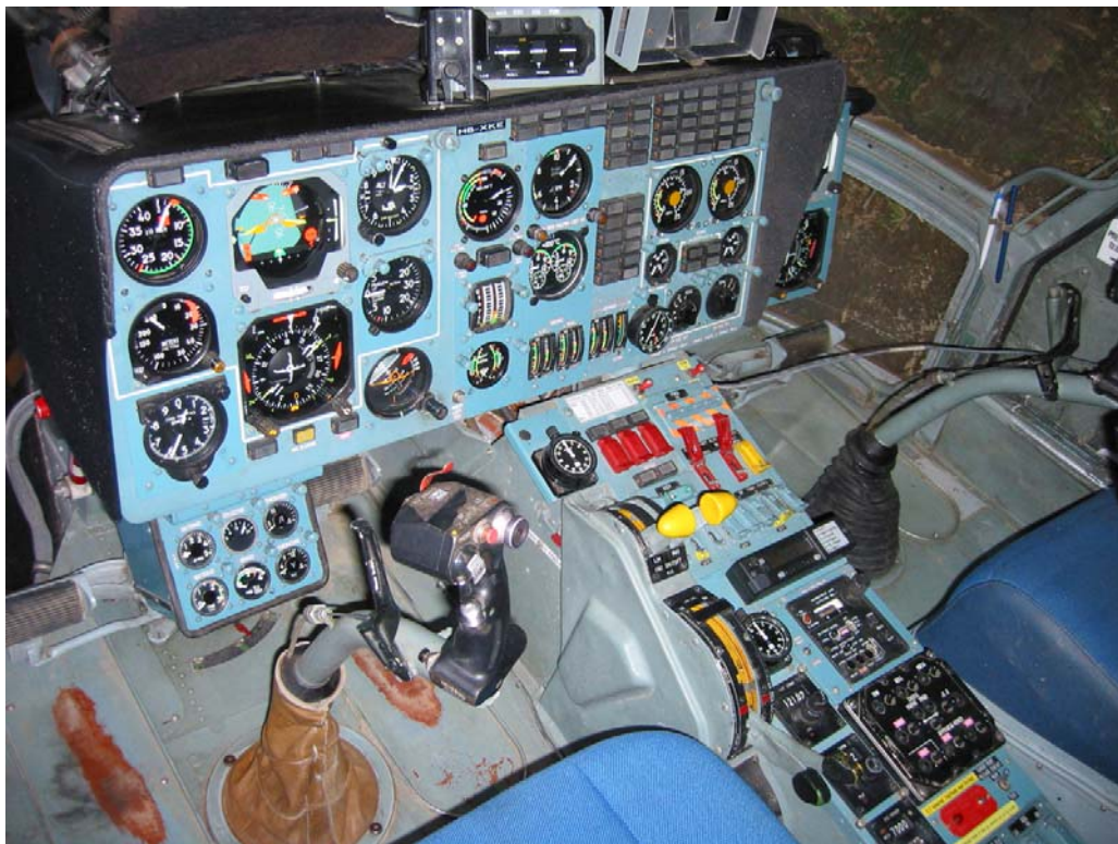
Fig. 1: Cockpit Layout – Instrumentenbrett und oberer Teil der Mittelkonsole
