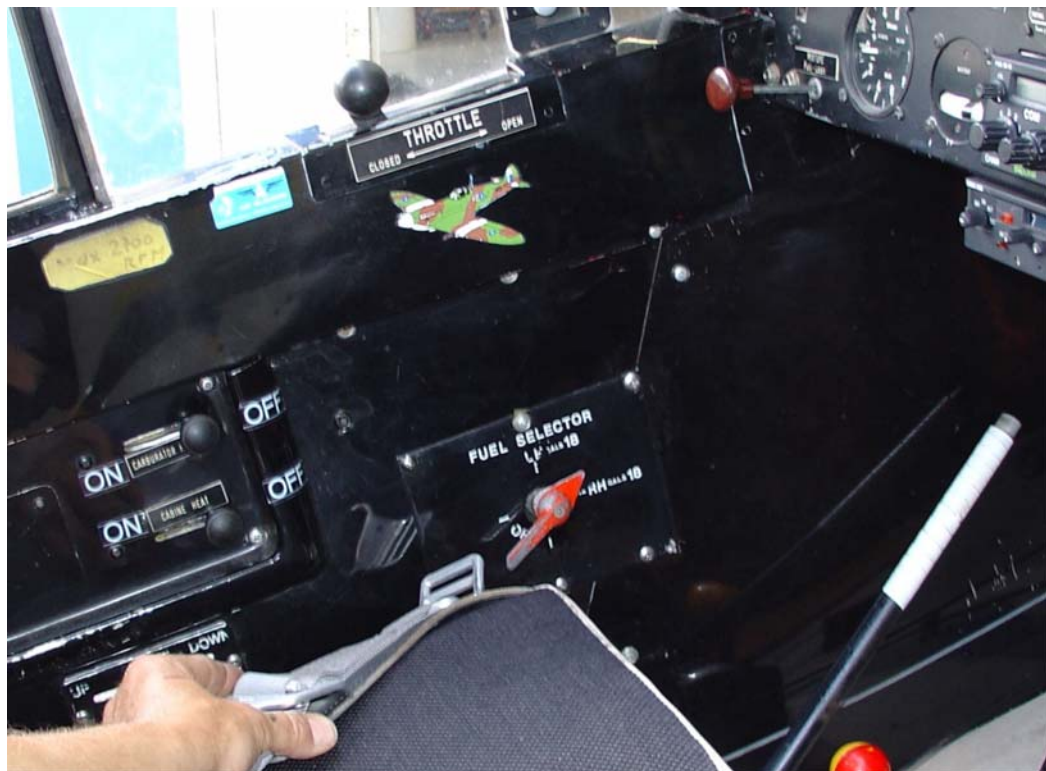
Fig. 3: Anordnung von Tankwahlhahn und Begurtung im Cockpit des Unfallflugzeuges
