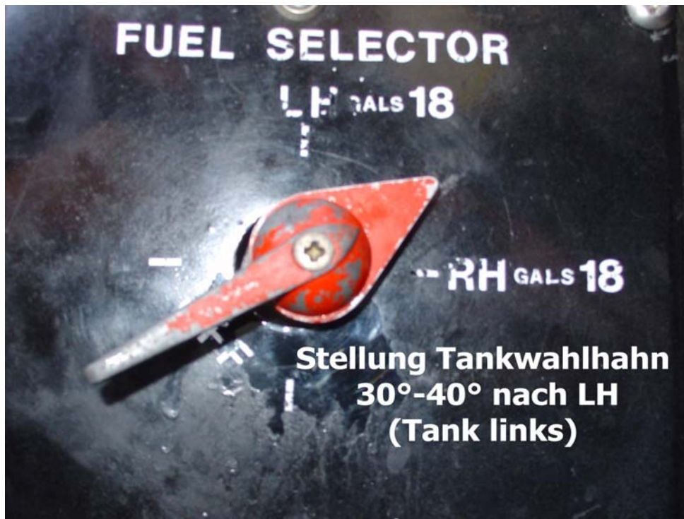
Fig. 2: Stellung Tankwahlhahn 30°-40° von RH gegen LH
