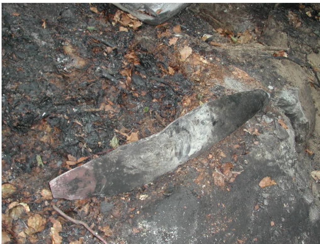
Foto 10: resti dell'aeromobile HB-EYZ. Pala dell'elica staccatasi dal mozzo.
