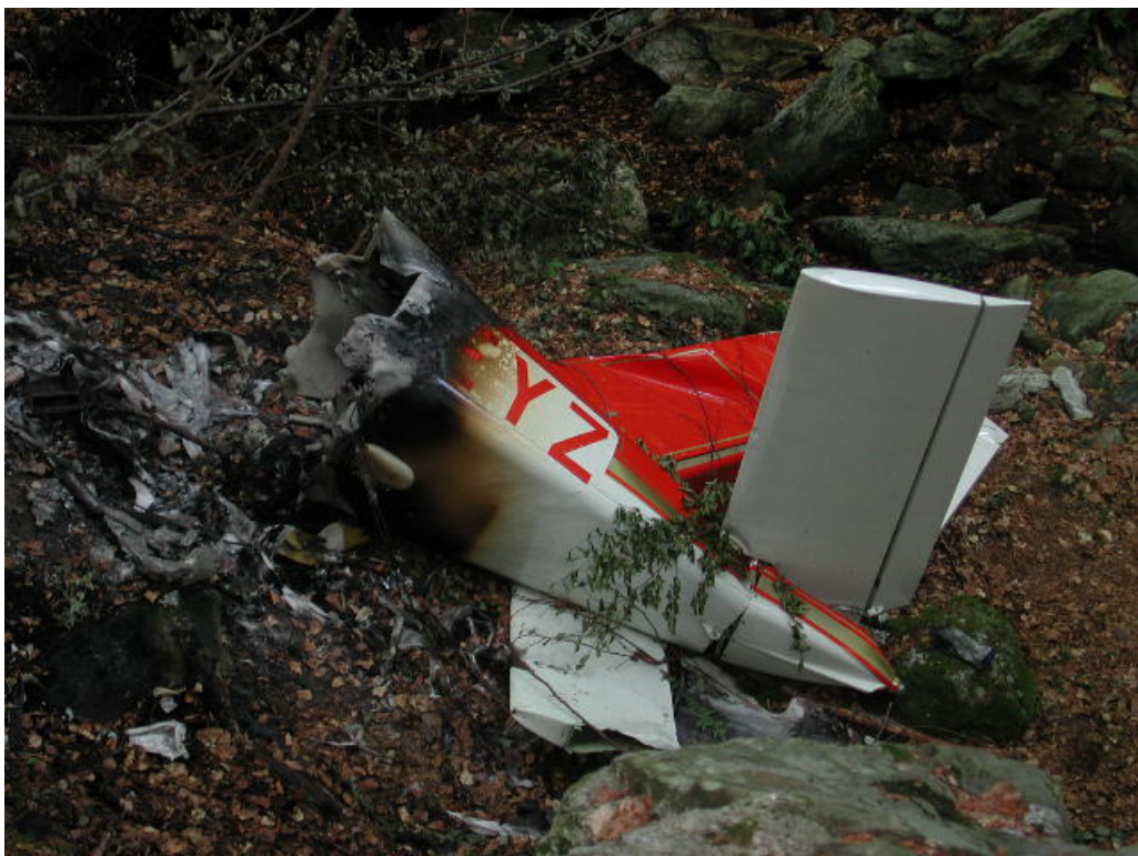
Foto 2: resti dell'aeromobile HB-EYZ. Particolare parte posteriore fusoliera.
