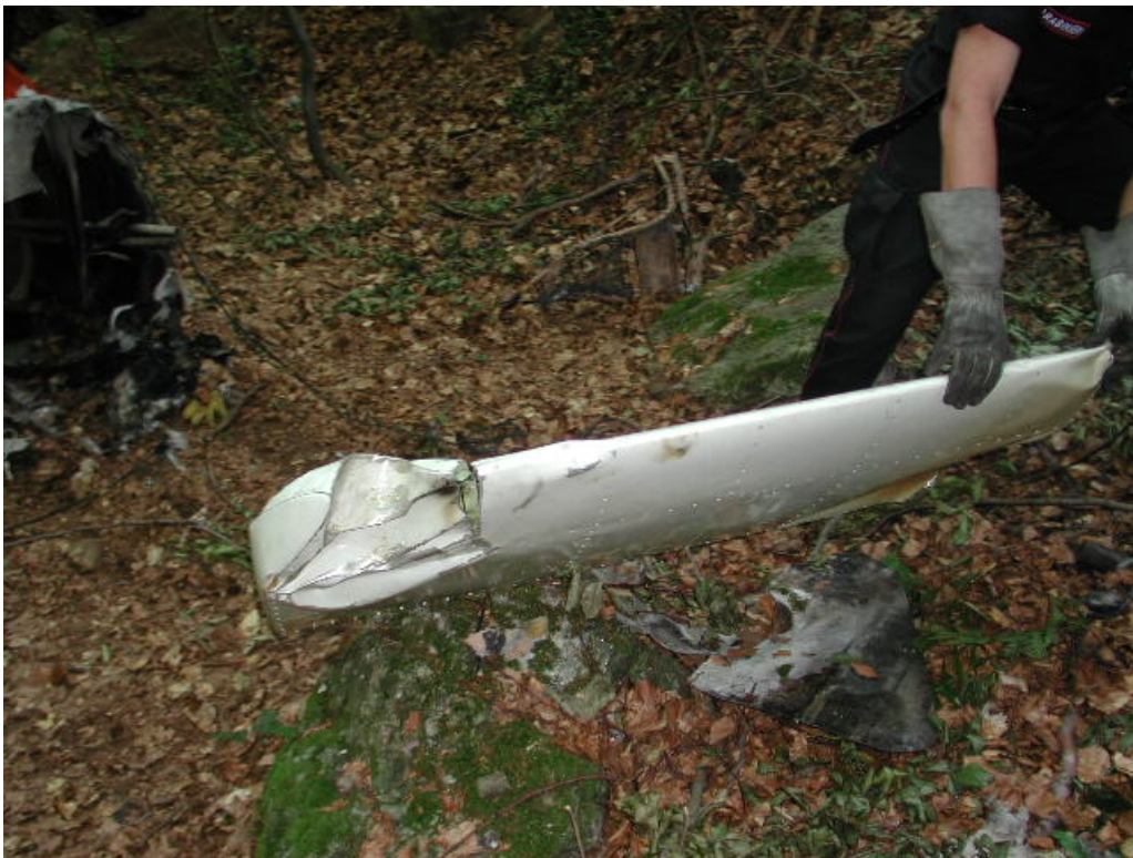
Foto 6: resti dell'aeromobile HB-EYZ. Particolare semipiano di coda orizzontale destro.
