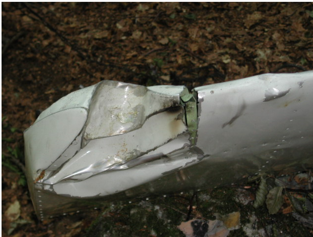
Foto 7: Particolare semipiano di coda orizzontale destro. Notare la deformazione in corrispondenza dell'estremità.
