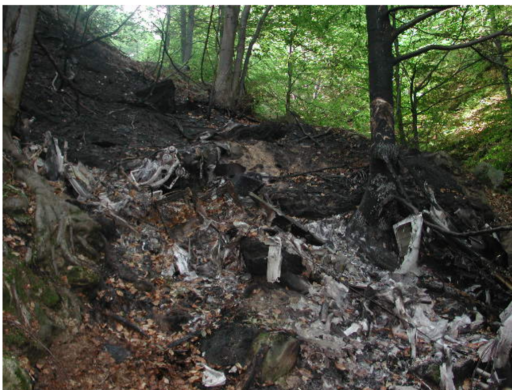
Foto 8: resti dell'aeromobile HB-EYZ. Parte anteriore fusoliera e motore.
