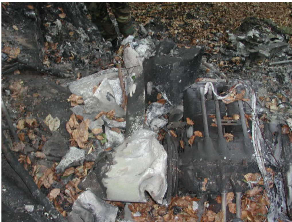
Foto 9: resti dell'aeromobile HB-EYZ. Parte motore, ogiva ed elica.
