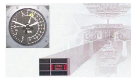
Dreifachinstrument zur Messung der Kabinendruckhöhe, des Kabinendifferenzdruckes und der Druckänderungsrate.
