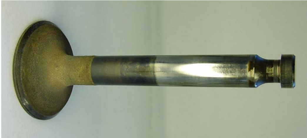
Auslassventil von Zylinder Nr. 3 mit Ablagerungen auf dem unteren Teil des Ventilschafts
