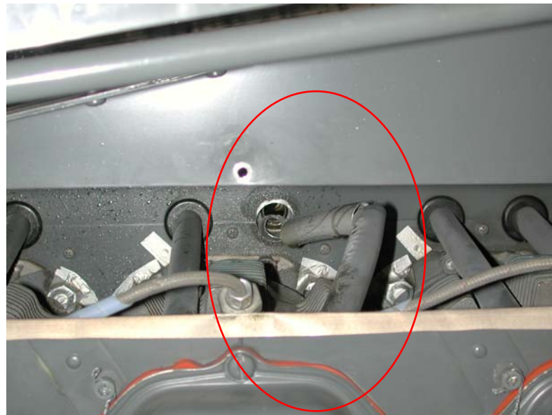
Gebrochene Auslassventil-Stößelstange am Zylinder Nr. 3.
