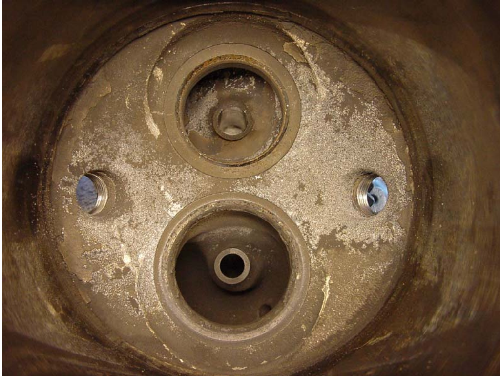
Brennraum von Zylinder Nr. 3. Gut sichtbar die zerklüfteten Ventilsitzflächen im Zylinderkopf, Auslassventil oben, Einlassventil unten.
