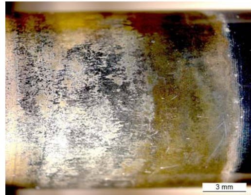
Mikroskopische Aufnahme der Ablagerungen auf dem Schaft des Auslassventils von Zylinder Nr. 3
