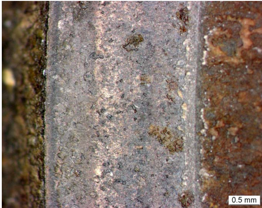
Koksrückstände auf der Sitzfläche des Auslassventils von Zylinder Nr. 3
