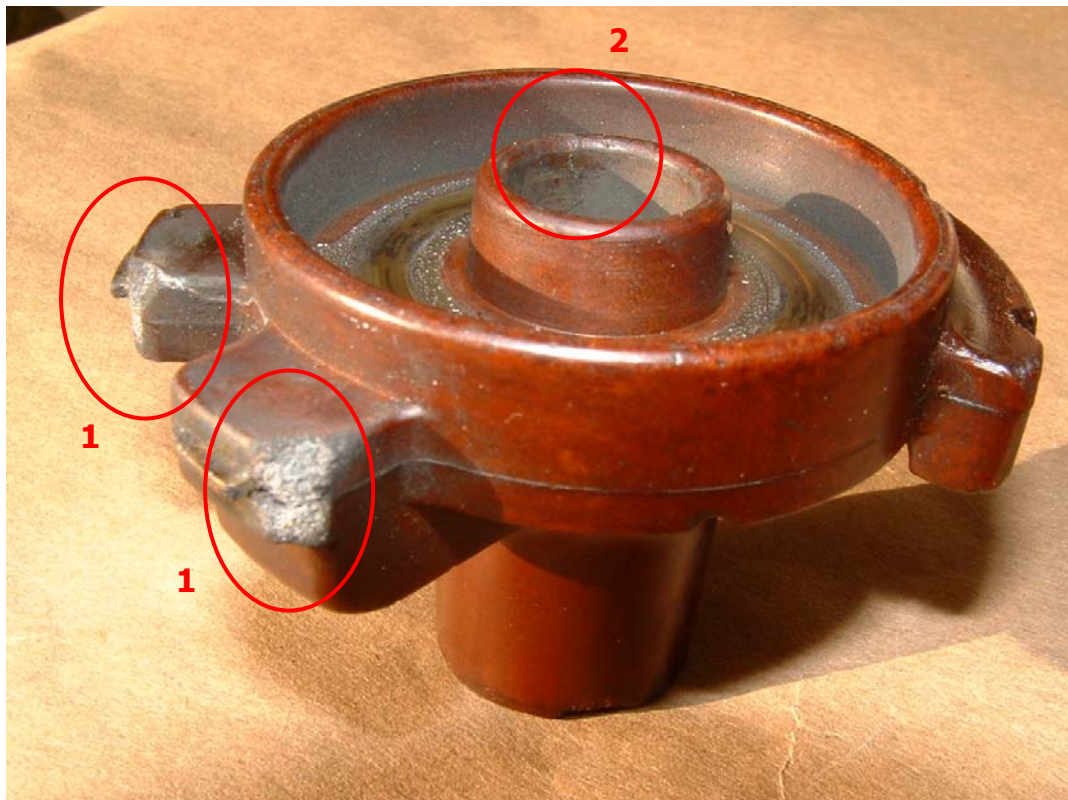
Fig. 5: Traces de brûlures sur les deux têtes du porte-éclateurs (1), de même qu'une fissure avec court-circuit entre les deux circuits secondaires (2).
