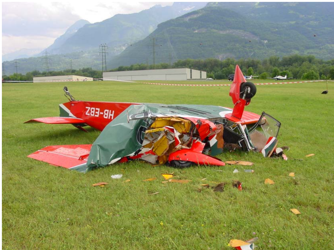
Fig. 3: Epave de l'avion, dont le moteur, le réservoir avant et la planche de bord ont été arrachés lors de l'impact.
