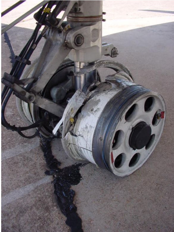
Foto n. 7, 8: particolari dei danneggiamenti ai cerchioni.
