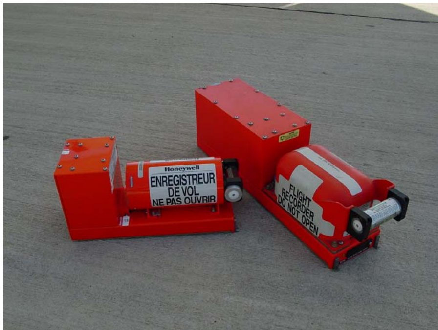
Foto n. 2: CVR (a sinistra) e FDR (a destra) del SAAB 2000 HB-IYB.
