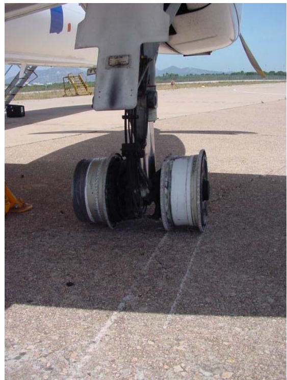
Foto n. 6: danni ai cerchioni carrello destro.
