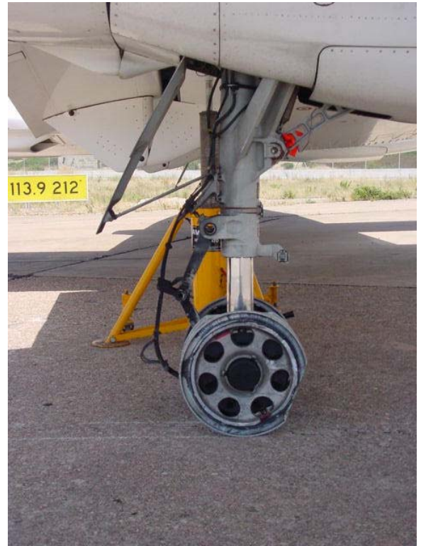
Foto n. 7, 8: particolari dei danneggiamenti ai cerchioni.
