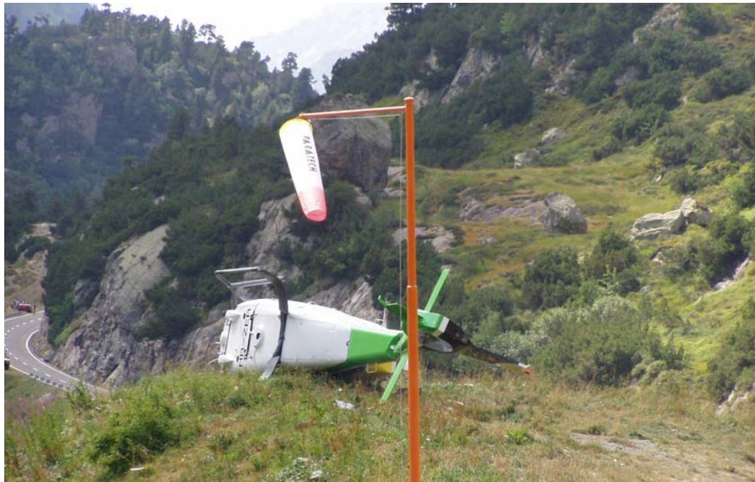
Photo 1 - Situation quelques minutes après l'accident: l'épave de l'hélicoptère repose au bord de la place d'atterrissage en montagne. Il souffle une ascendance de pente provenant de l'ouest.
