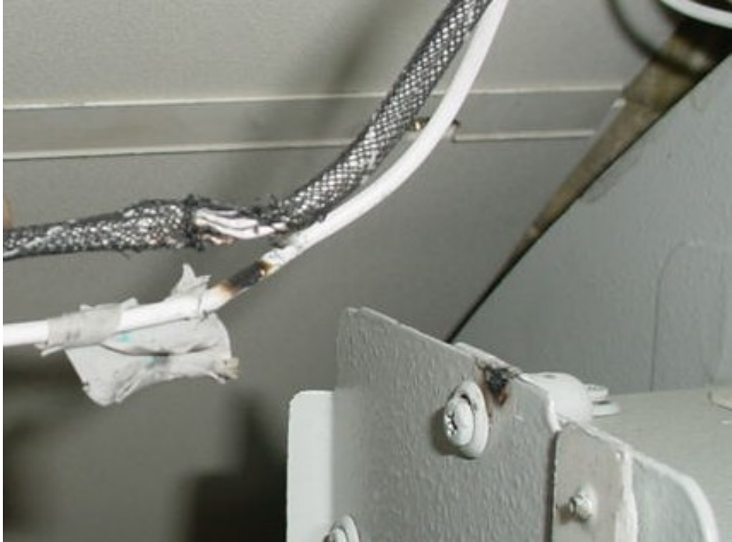
Abbildung 1 – Schadenbild hinter der vorderen Bordküche: Die Isolation der Kabel ist beschädigt. Die Hitzespuren an den Kabeln und der Flugzeugstruktur zeigen, dass ein Lichtbogenüberschlag stattgefunden hat.
