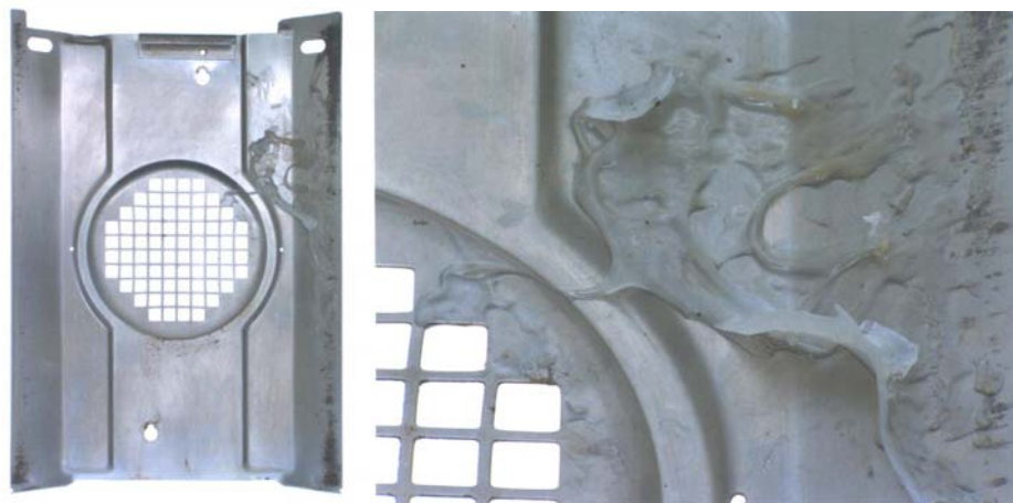
Abbildung 3 – Herausnehmbare Rückwand des rechten Ofens: Übersicht (links). Detailaufnahme: Kunststoffähnliche Anhaftung, charakteristisch verformt (rechts).
