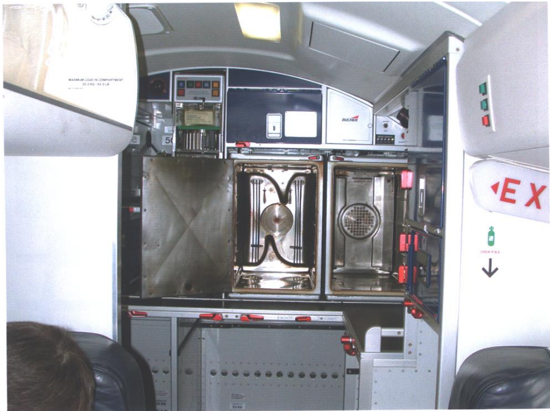
Abbildung 1 – Hintere Bordküche nach dem schweren Vorfall: Blickrichtung gegen das Heck. Beim in Flugrichtung gesehen rechten Ofen (Bildmitte) fehlt die herausnehmbare Rückwand. Sichtbar sind Gebläserad und links bzw. rechts davon je drei Heizelemente. Der linke Ofen – aufgrund der Blickrichtung hier rechts im Bild – weist die normale Betriebskonfiguration mit eingesetzter Rückwand auf.
