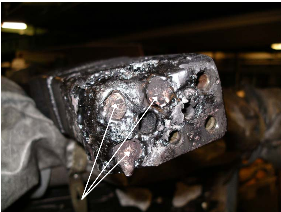
Die drei von der flugzeugseitigen Steckerplatte weggeschmolzenen Kontaktstifte
