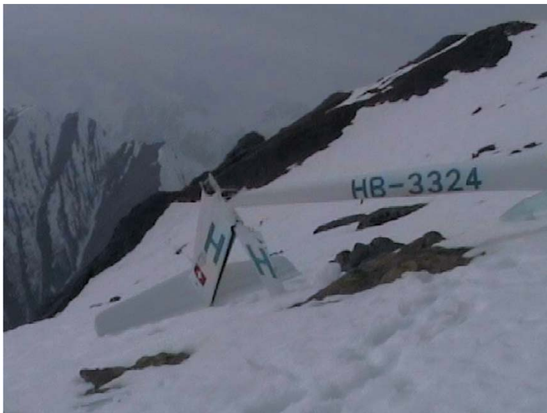
Rottura della trave di coda.
