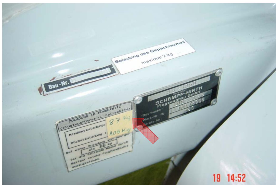
Charge utile minimum affichée à droite du siège pilote
