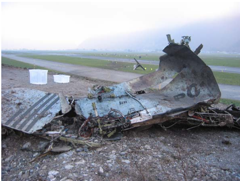
Endlage Hauptholm / Flügelmittelektion
