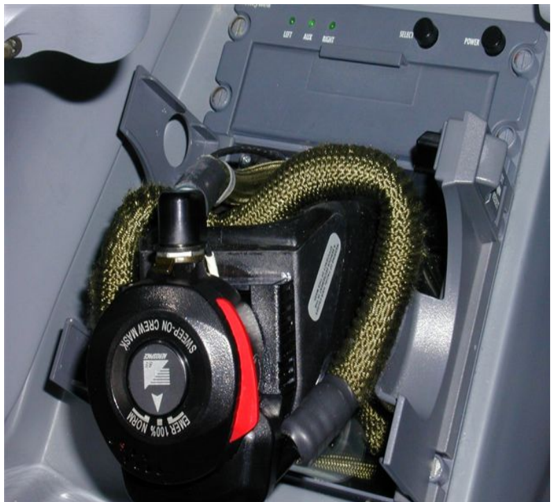
Sauerstoffmaske, halb aus der ‚stowage box‘ gezogen
