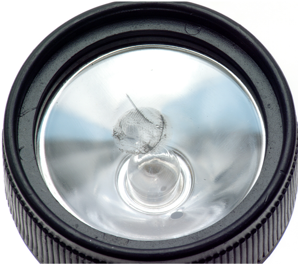
Abb. 1 Linse der Taschenlampe mit geschmolzenem Plastik
