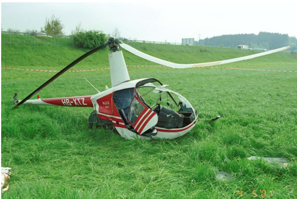
Verformung der Blätter durch «CONING» und «Rotorstall» (Helikopter aufgestellt)
