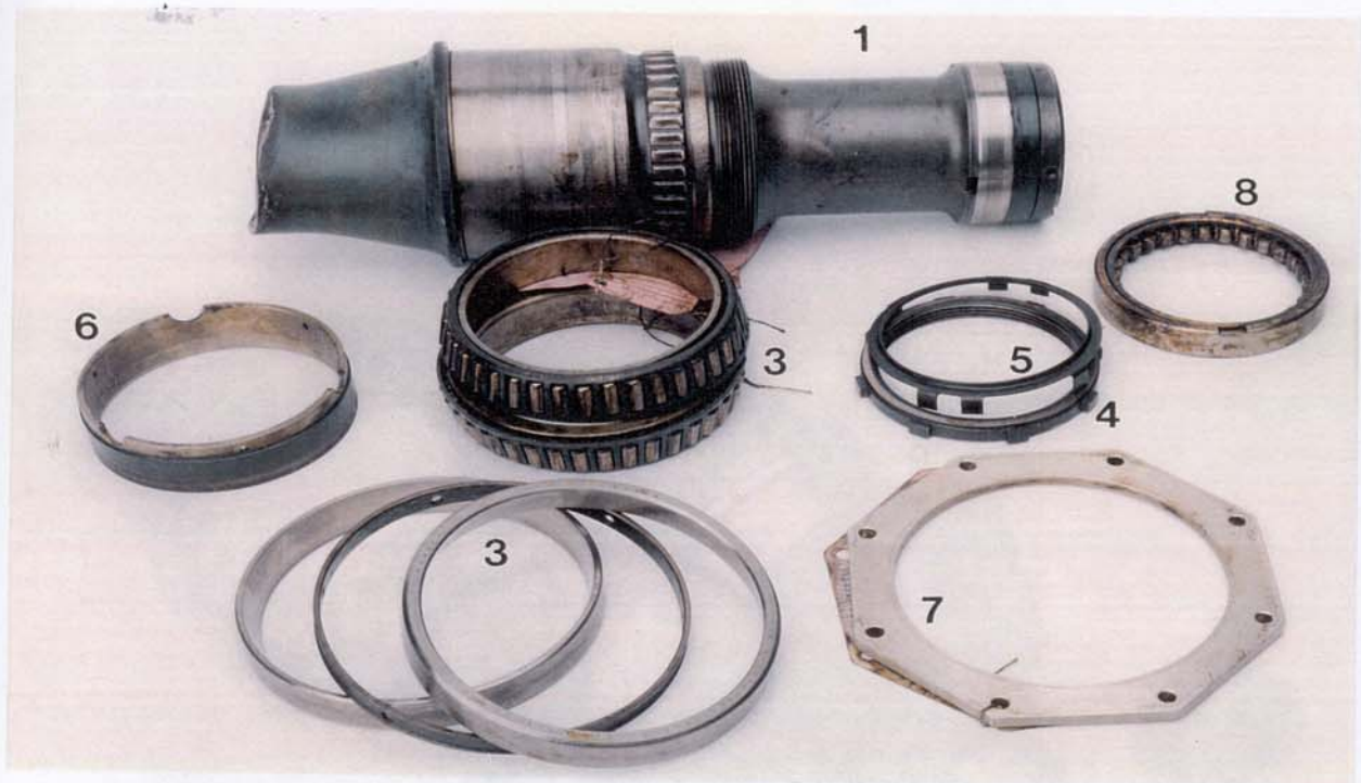
Cliché 1 : Arbre rotor repéré 1 et autres composants
