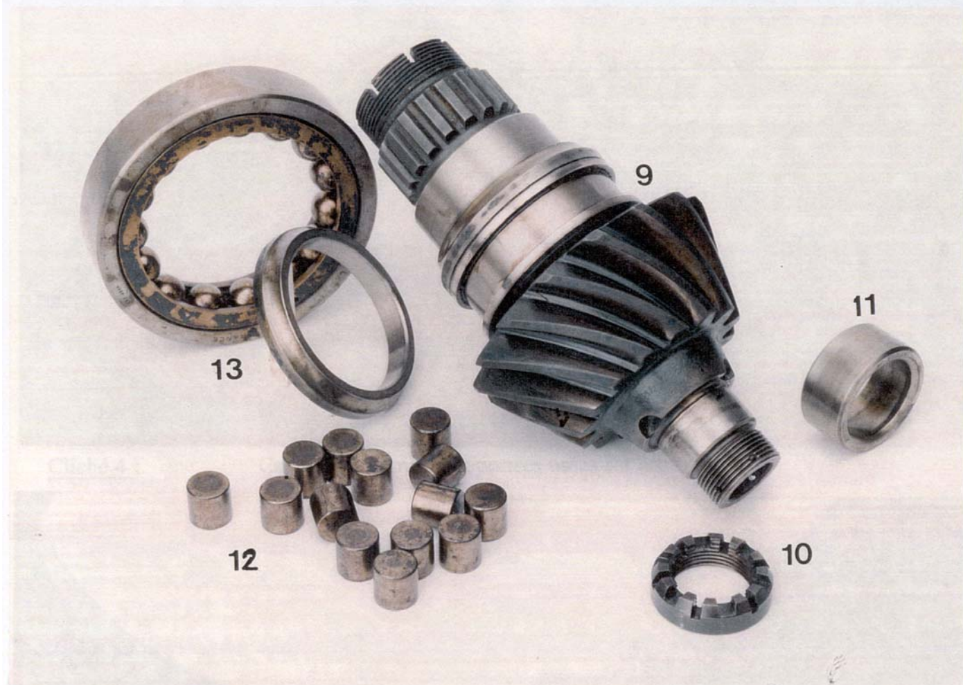
Cliché 3 : Pignon conique d'attaque repère 9 et composants associés fournis
