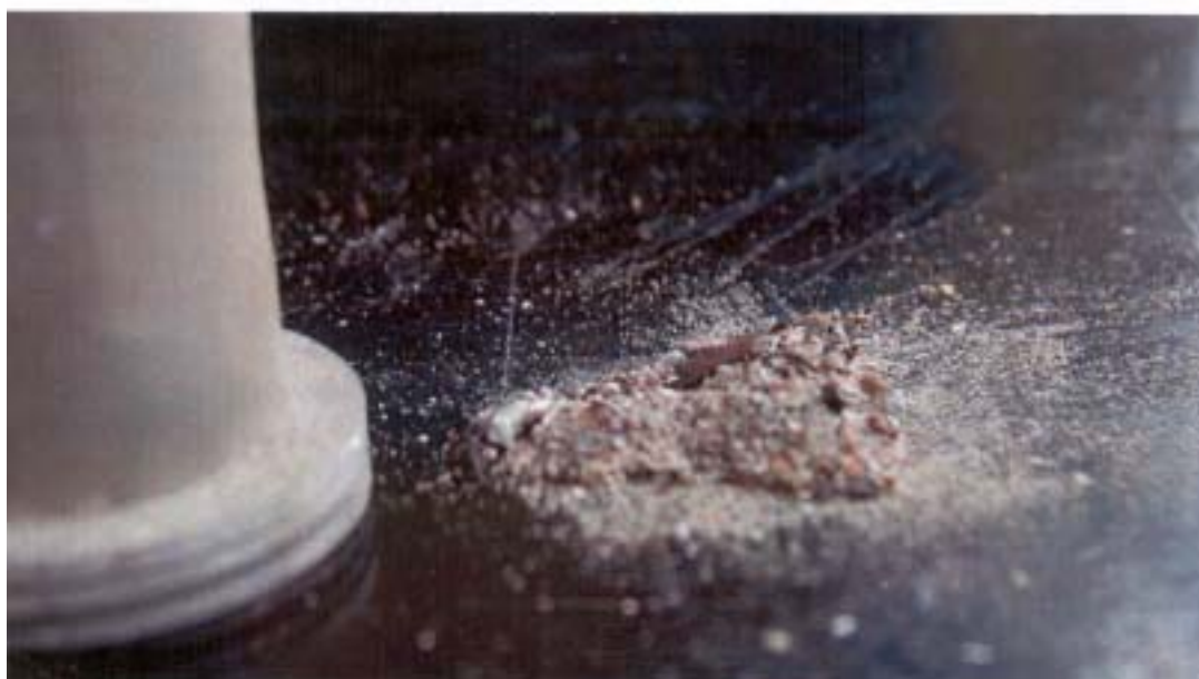
Sopra: Incrostazioni chiare sulla testata del pistone Sotto: Deposito di impurità nel filtro del carburante
