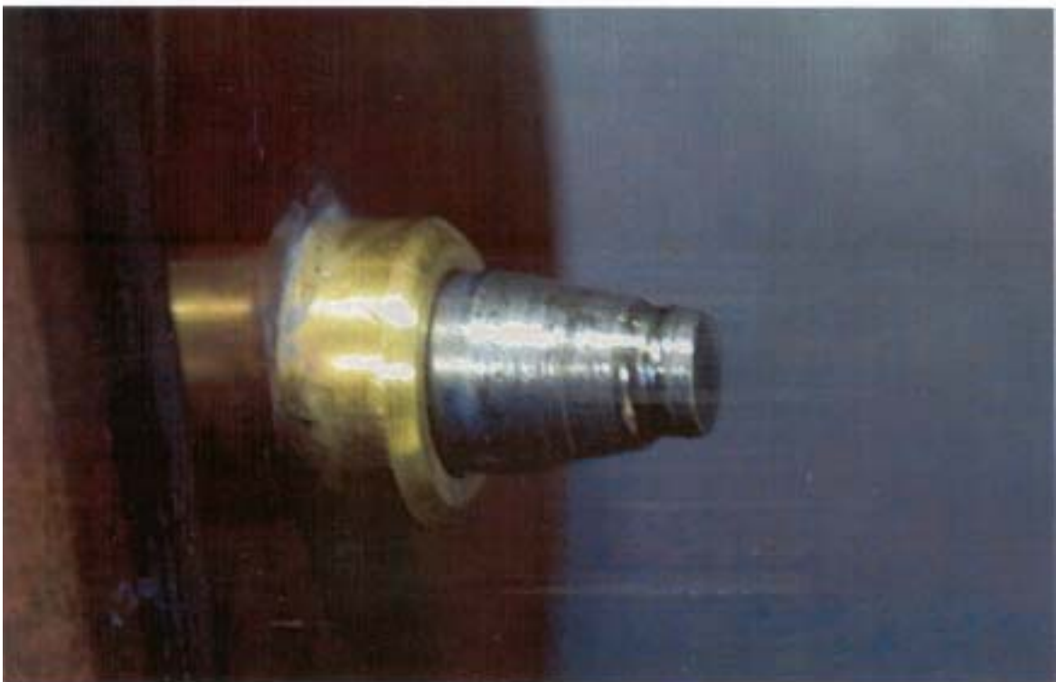
Sopra: Posizionamento errato dell'asta di comando Sotto: Usura anormale dell'asta di comando
