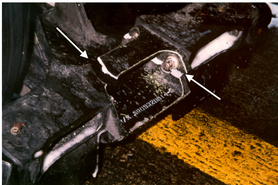
Détails des deux cassures dans l'élément de liaison (flèches)
