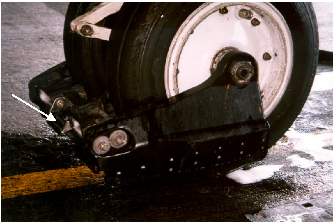
Vue générale du déflecteur avec zone de rupture (flèche)
