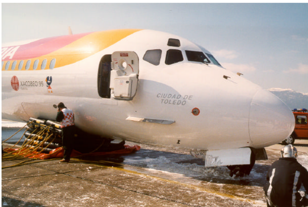
Situation des roues avant au cours de l'opération de levage
