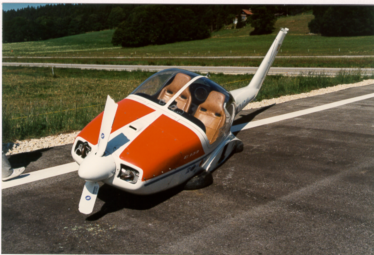
Fuselage après démontage des ailes et du gouvernail de profondeur, hélice et train d'atterrissage gauche brisés
