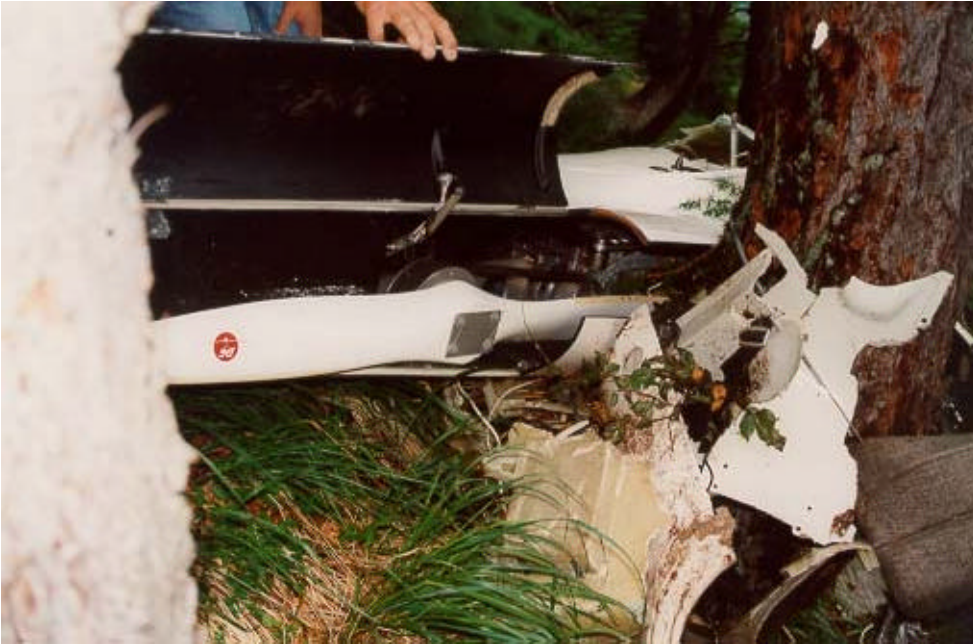
Motore rientrato ed elica intatta
