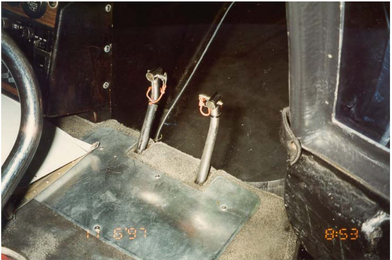
Heckrotorpedale der HB-XMO mit entfernten Fussablagen
