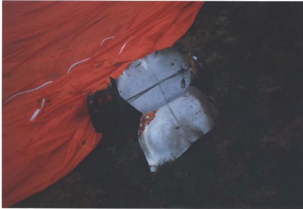
Alu-Zylinder geborsten unter Hülle, ca. 6 km vom Korb entfernt
