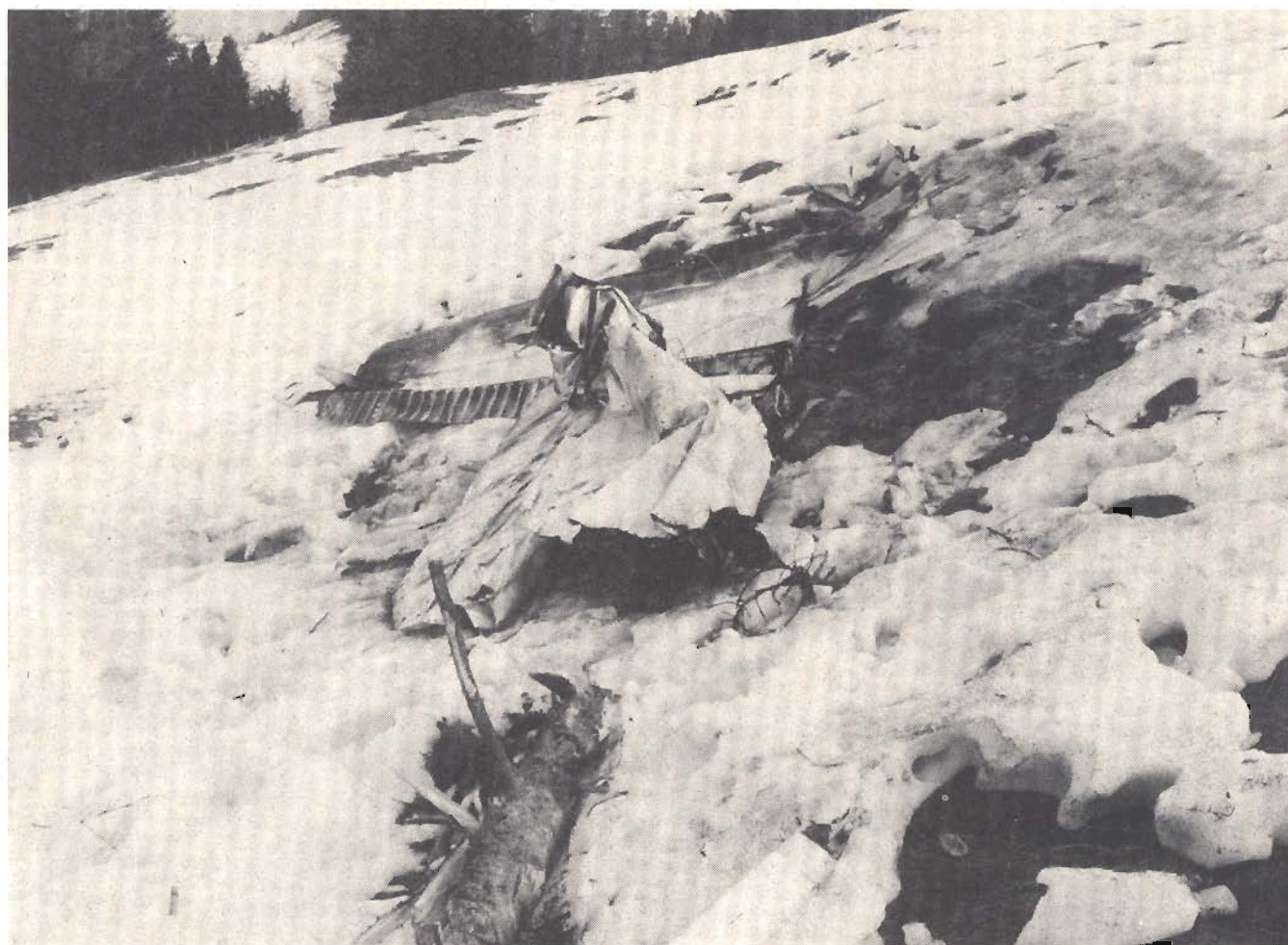
oben: die beschädigten Bäume unten: der entzwei gebrochene linke Flügel mit einem Stück Tanne
