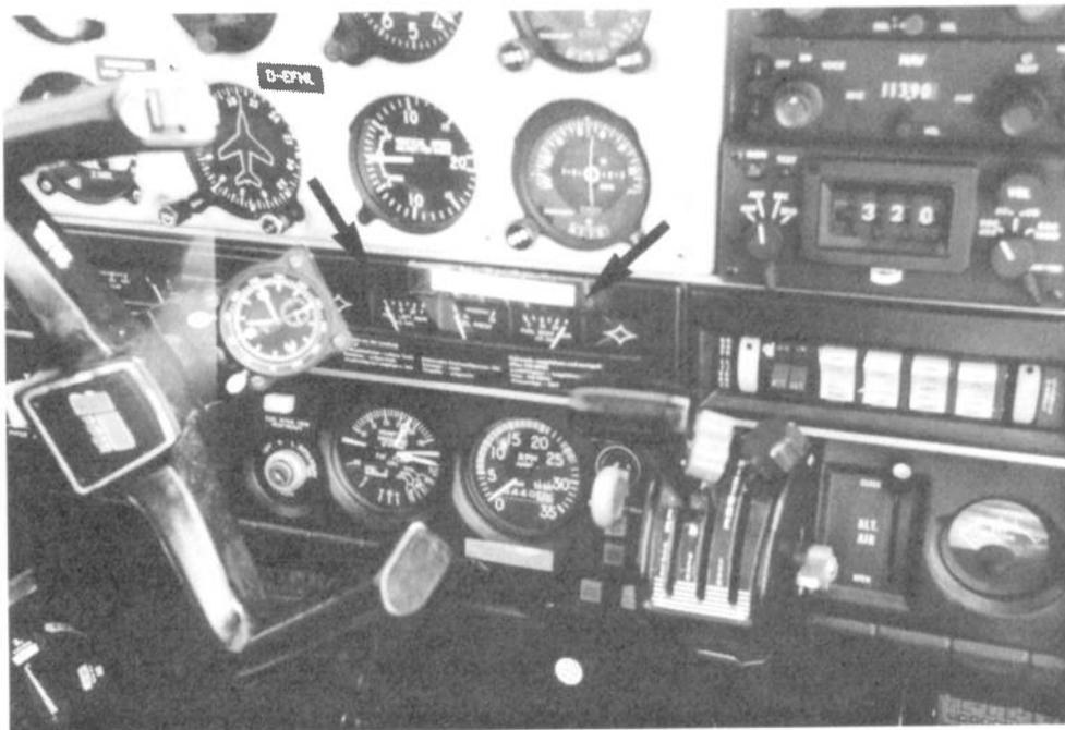
Oben: Stellung des Tankwählhahnes bei der Prüfung des Cockpits
