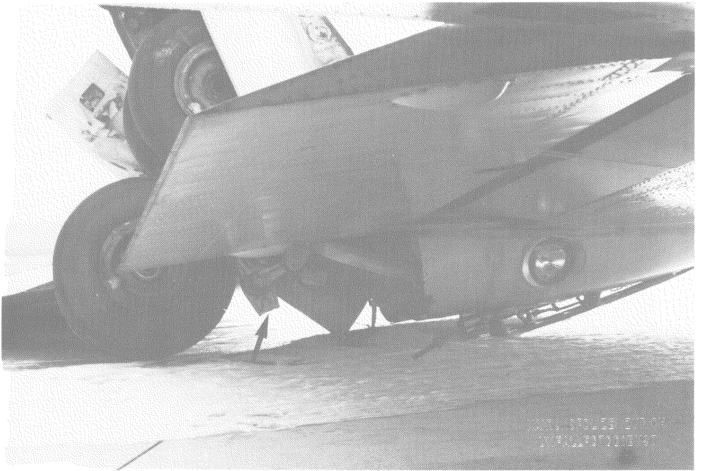
Das eingeknickte linke Fahrwerk mit primärer Bruchstelle (Pfeile)
