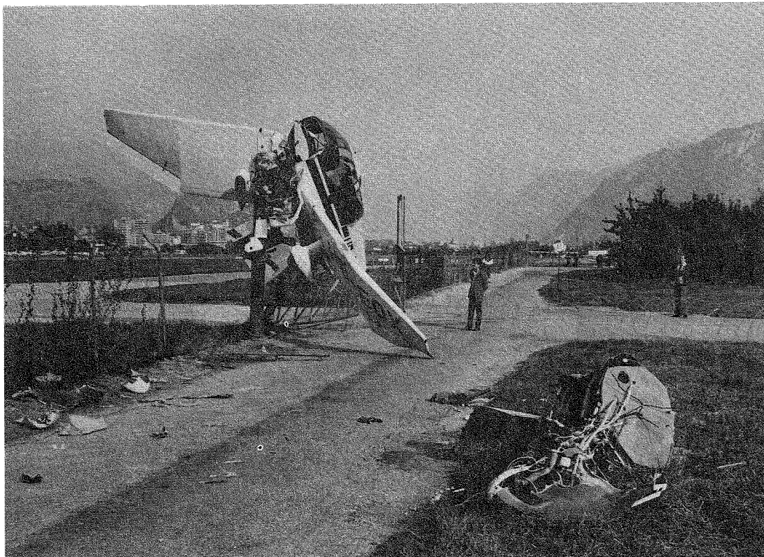
VUE DE L'AVION EN DIRECTION NORD/EST, AU PREMIER PLAN GROUPE MOTOPROPULSEUR ET PLANCHE DE BORD.
