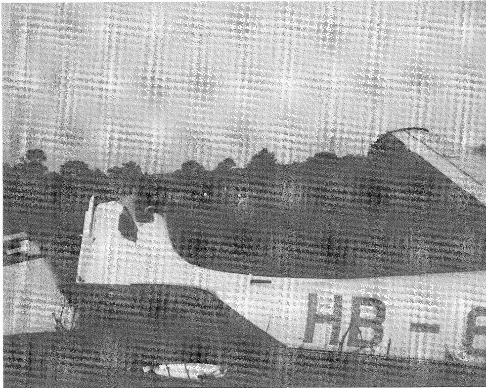
Vue rapprochée de la dérive du HB-635 sectionnée à mi-hauteur
