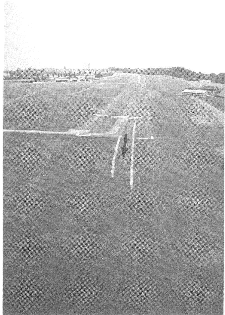
Traces des roues gauche et droite du train principal Wheel-marks of the left and right main landing gear
